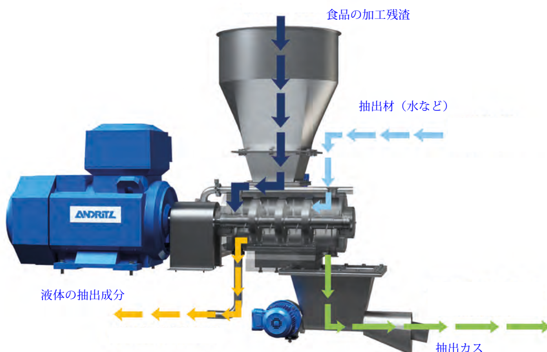
Turbex 抽出機の動作原理
